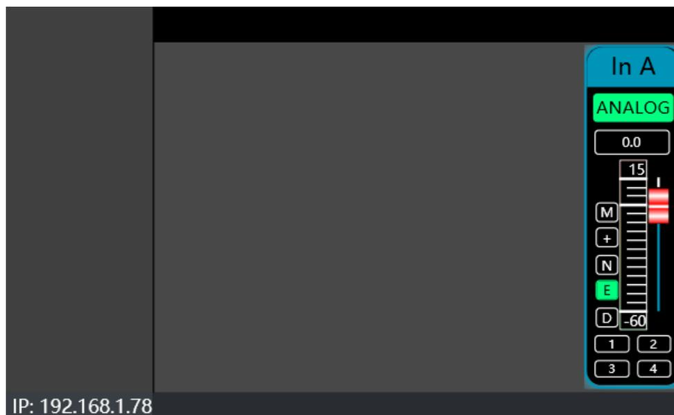
当软件打开时，则会自动获取设备连接的电脑系统的 IP 地址，如果出现 2 个 IP 地址，一般默认第一个是无线网卡 IP 地址，第二个才是有线网卡的 IP 地
