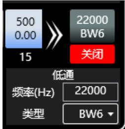
可控制开关、高低通的频率及类型，滤波器类型斜率最高48dB。
