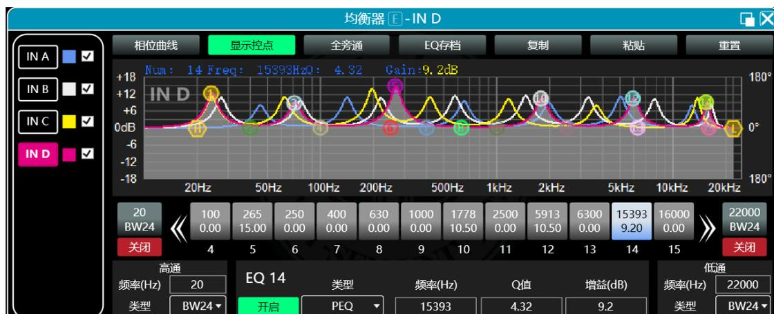
如上图所示，左侧 **In A** 为每个通道的界面切换按钮，点击切换 EQ 通道，彩色为当前选择的通道。 **■** 为 EQ 通道的曲线颜色。 **☑** 为每个通道的 EQ 曲线显示开关，勾选为打开，可以实现在当前通道界面，显示其他通道的曲线。
